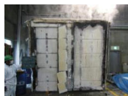
2時間耐火構造性能試験
