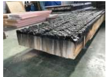
脱炉後の試験体 燃え抜けや過度の炭化は見られない。
